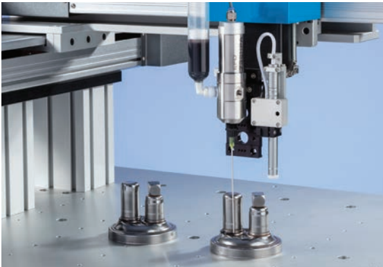
La válvula de 736 dosifica grasa en un componente de la bomba de gasolina.
