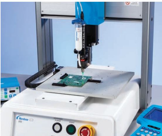
La válvula 794-TC está diseñada para aplicar depósitos precisos y repetibles de material de interfaz térmica
